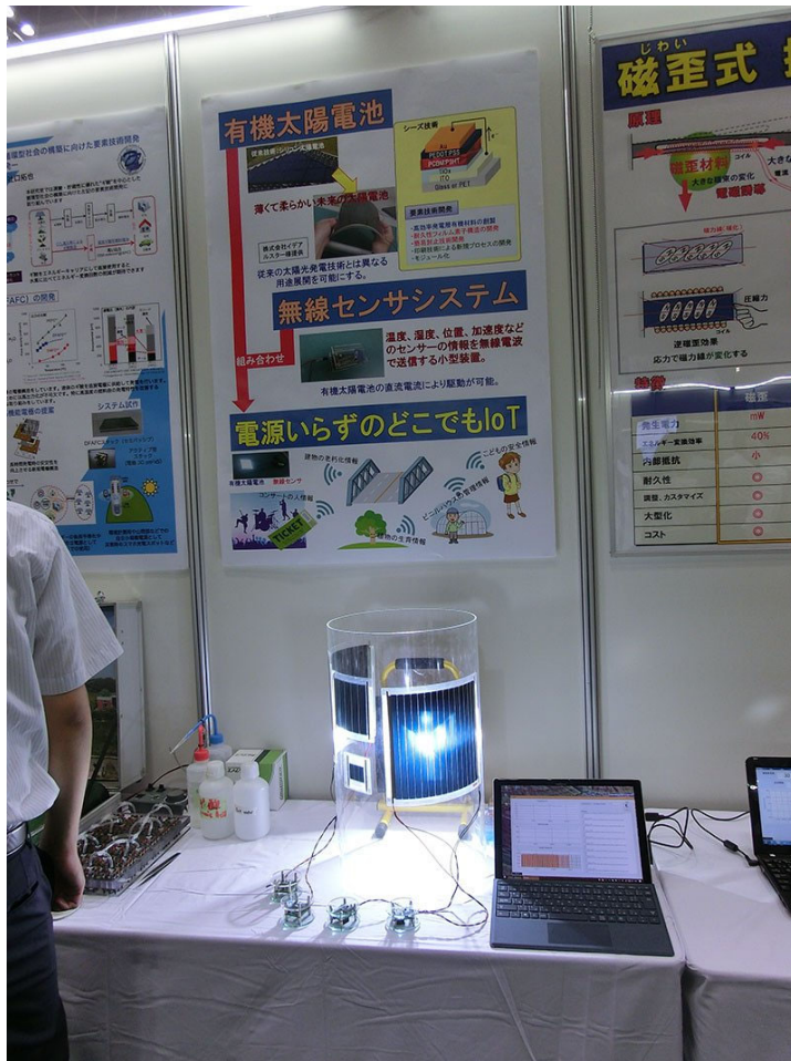
フィルム太陽電池による無線センサネットワーク(Innovation Japan)
