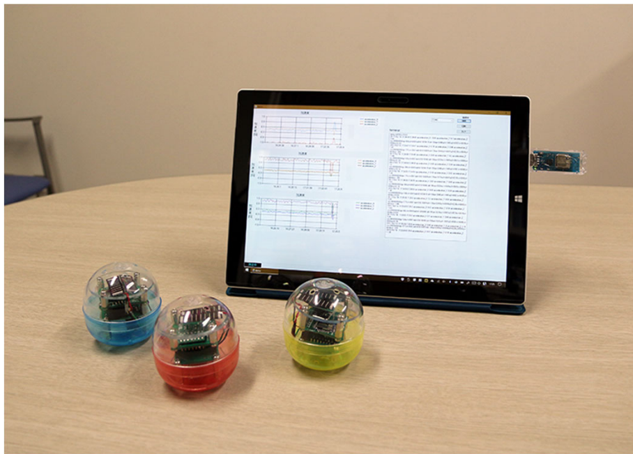
振動発電による無線加速度センサのデモ
