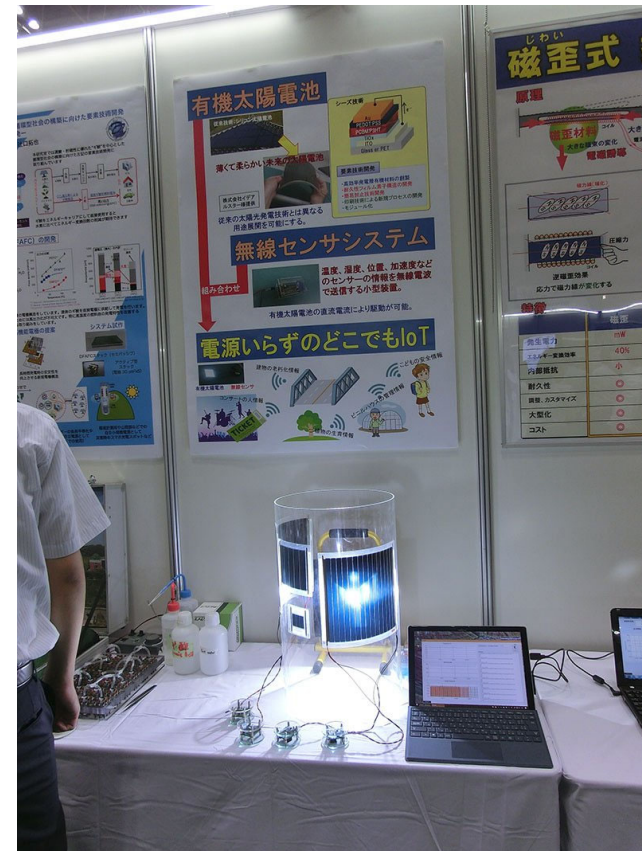
有機薄膜太陽電池による無線ネットワークのデモ
